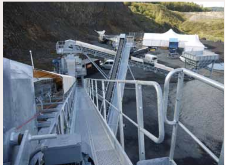
ABGEFEDERT: Seit Neuestem lagern die Ammann-Ellipsenschwingsiebe auf Rosta-Schwingelementen und der Antriebsmotor ist auf eine selbst nachstellende Rosta-Motorwippe montiert. Das verbesserte Schwingungsverhalten bei Einsatz der Rosta-Lagerungen zeigt die Grafik. Foto und Grafik: Rosta
