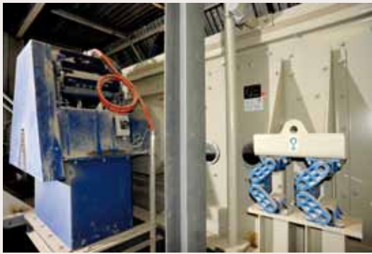
ABGEFEDERT: Seit Neuestem lagern die Ammann-Ellipsenschwingsiebe auf Rosta-Schwingelementen und der Antriebsmotor ist auf eine selbst nachstellende Rosta-Motorwippe montiert. Das verbesserte Schwingungsverhalten bei Einsatz der Rosta-Lagerungen zeigt die Grafik. Foto und Grafik: Rosta
